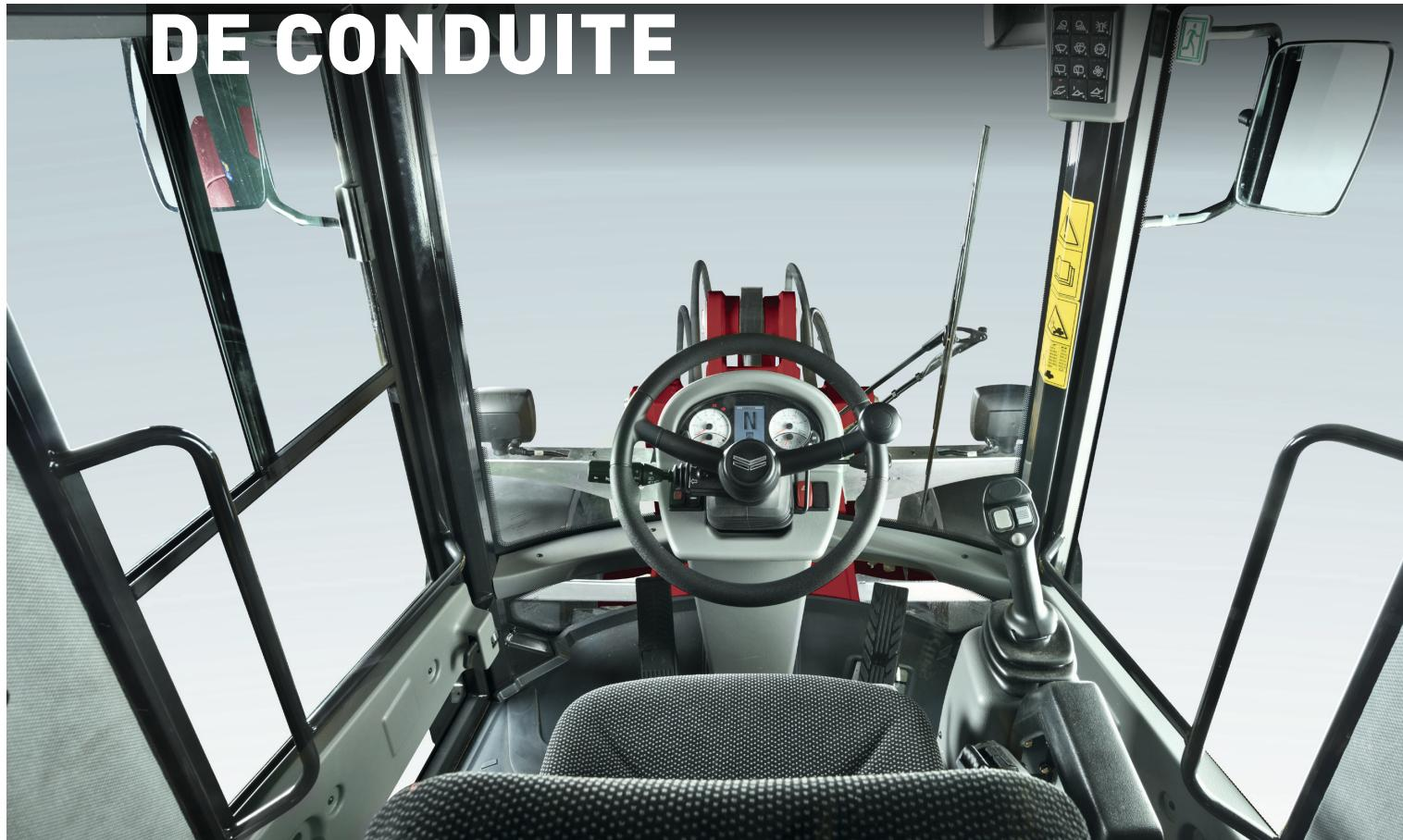
Conçue dans un souci de confort de l'opérateur et de productivité, la cabine présente un amortissement du bruit et des vibrations et est homologuée ROPS/FOPS.
