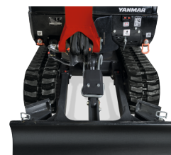
Tren de rodaje retraído : 980 mm
