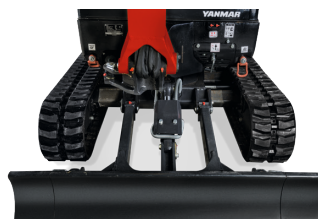
Tren de rodaje extendido : 1 380 mm
