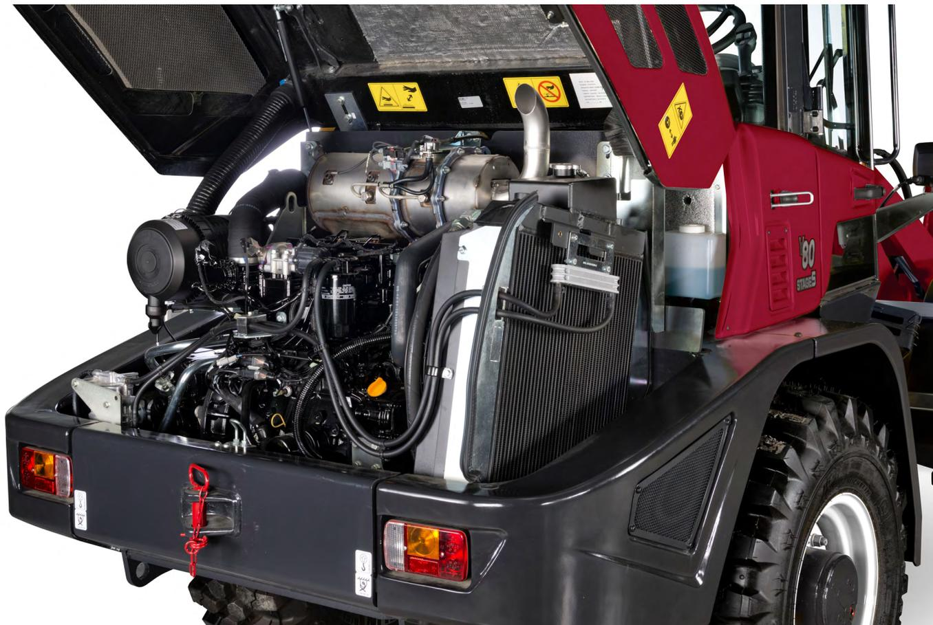
La gran apertura que presenta el capó del motor permite acceder fácilmente a los elementos principales del funcionamiento de la máquina para realizar labores de mantenimiento fáciles y rápidas. Esto contribuye a reducir el CTP de la máquina. Las tareas de mantenimiento diarias pueden llevarse a cabo desde el suelo para ahorrar tiempo.
