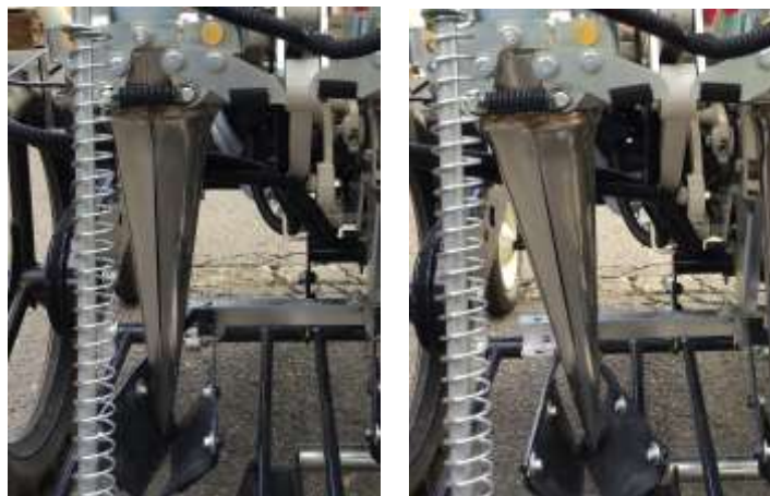
＜開孔器の姿勢により条間を調節する「条間調節機構」イメージ＞
