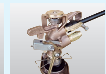
アームノズル取り外し状況
