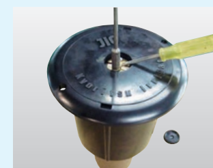
蓋カバー取り外し状況
