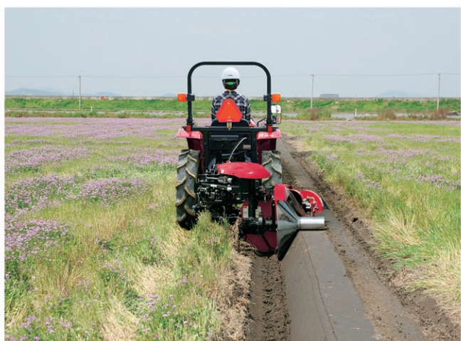
あぜ塗り機(小橋工業)
