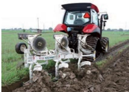
プラウ作業時の燃料消費量を約20%削減。自動制御で省エネ運転。作業負荷に応じてエンジン回転と車速を自動で制御し、能率よく高精度な作業ができます。
