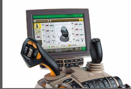
コマンドアーム 作業に必要な操作系を肘掛けに集約。肘掛けに腕を置いたまま作業操作が可能。
