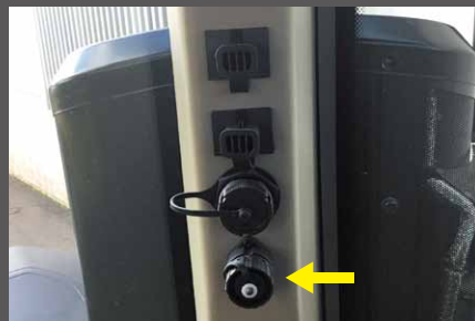
信号取出し (7極) 車速 (対地速度、ホイール速度) の信号を取出すことができます。ISO11786に準拠
