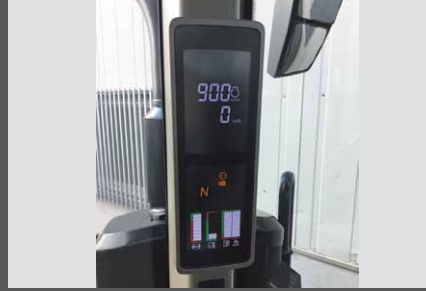
コーナーポストディスプレイ 作業に必要な情報を表示。(エンジン回転、車速など)
