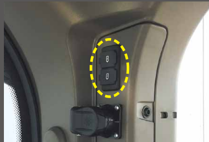
USB充電ソケット (4つ) キャビンの中で携帯電話やタブレットの充電が可能。5A (60W)
