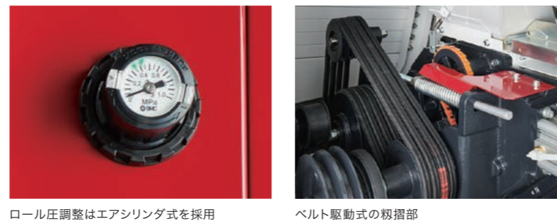
ロール圧調整はエアシリンダ式を採用
