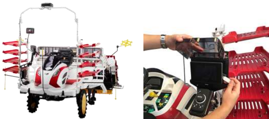
<直進アシスト田植機可変施肥仕様(左)と施肥マップデータの取り込み(右) イメージ>
