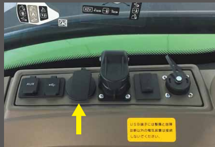
アクセサリソケット 12Vの電源として使用可能。
