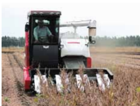
YH700M 用 4畦ロックroppヘッダー ユニット：CRC4,700M プラットフォーム：CRC700M,PF
