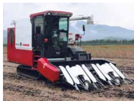
YH1150A 用 4畦ロックroppヘッダー ユニット：CRC4,1150A プラットフォーム：CRC1150A,PF GC950/GC980/AG1100/AG1140R/YH1150にも適応
