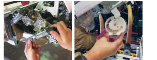
プッシュロッドの点検
