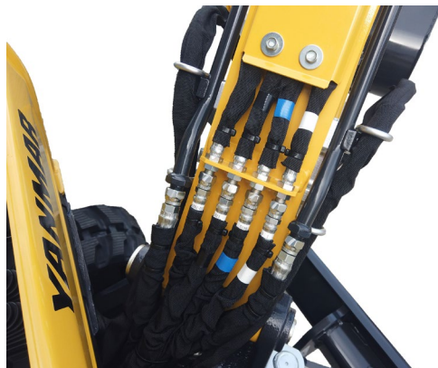
＜左：標準搭載のオイルクーラー、右：分割シリンダーホース＞
