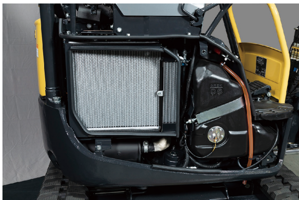
＜左：標準搭載のオイルクーラー、右：分割シリンダーホース＞
