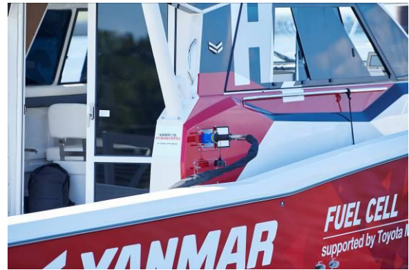
<70MPa 高圧水素充填試験の様子>
