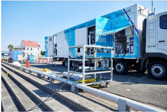
<70MPa 高圧水素充填試験の様子>
