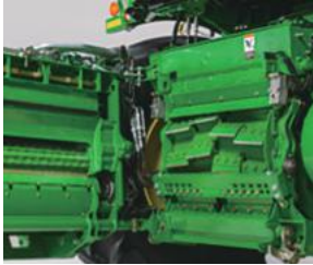
フィードロールハウジングは回転開放式、取外しが容易で便利で、メンテナンス性がいちだと向上しました。
