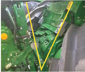
ヘッダーをつけたままV型に開閉が可能なのでナイフの調整や金属・石探知機のメンテナンスもラクにできます。
