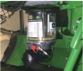
自動集中注油装置で手間いらず。あらゆる潤滑箇所、常に新しいグリースが自動で潤滑されます。
