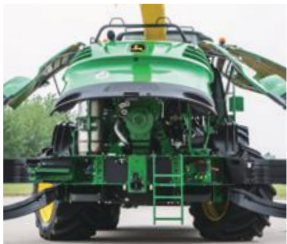
後部パネルとサイドパネルが大きくオープンでき、エンジン各部のメンテナンスがラクに行えます。
