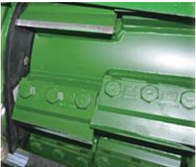
カッターヘッドのナイフ交換も簡単。ボルトをまわしてナイフを外し、新しいナイフをつけるだけです。
