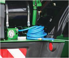
コンプレッサーを装備しているのでエンジン周辺の塵埃の掃除が容易にできます。
