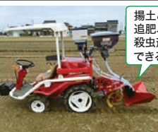
正逆中耕ロータリー RU400AZ (Vローター) +排土板2輪 +施肥機VR05HAH,FTMH +薬剤散布機+サンバイザー
