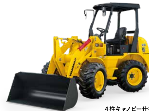
4柱キャノピー仕様 (ROPS/FOPS※1基準)
