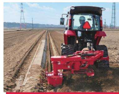
仕上げの四隅の溝掘りはバック作業。自動でまっすぐ後進し、四隅まできれいに溝掘り作業が行えます。
