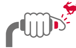
4 走行2速スイッチ 足元のスイッチから、手元操作へ。ブレードで敷均しをしながら、走行速度の変更が容易にできます。
