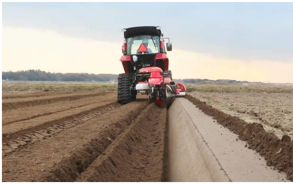
<直進アシスト機能によるあぜ塗り、うね立て作業イメージ>
