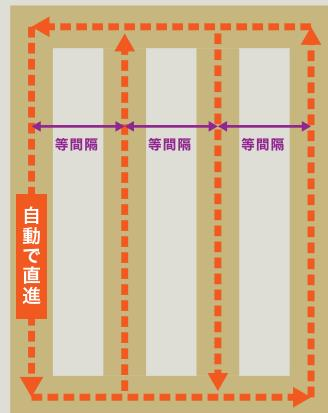
ほ場内に溝を掘るときも作業幅を設定すれば、自動で等間隔に。ほ場内にまっすぐ、等間隔で溝が掘れるので、後工程のうね作りや他の作業もラクに行えます。
