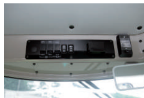
ヒータースイッチ組み込みの オーバーヘッドコンソール
