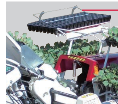
確実に空トレイを押さえる「空トレイ押さえ」
