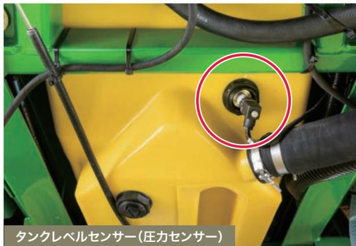
タンクレベルセンサー(圧力センサー)
