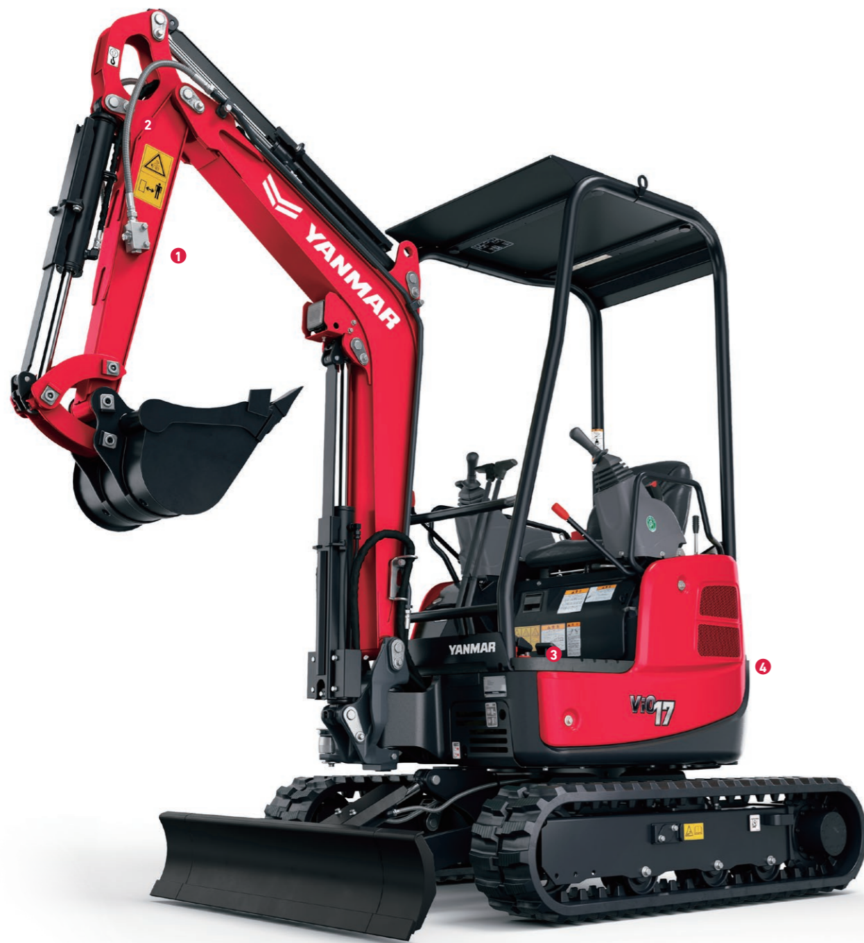
4柱キャノピー仕様(ROPS/FOPS基準※)
