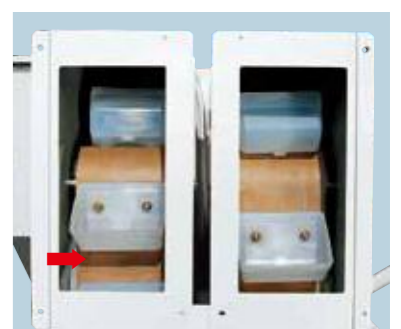
籾が溜まりにくいコンベアバケット取付部
