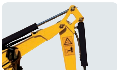
バケットシリンダーホースのarm内装化
