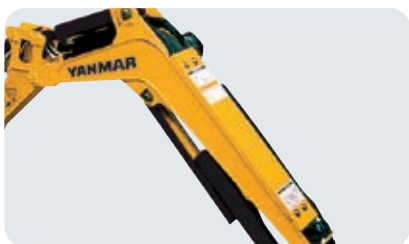
boom背面ホースとboomシリンダーに保護カバーを採用
