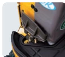
はね上げ格納式ペダル(走行2速/P.T.O.ペダル)
