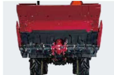
延長爪軸キット (センターロータリー用) 1B1500-29011-2 ※片側100mm
