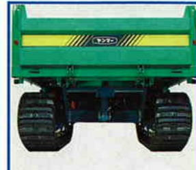
走破性にすぐれたワイドな履帯とゆよりの地上高
