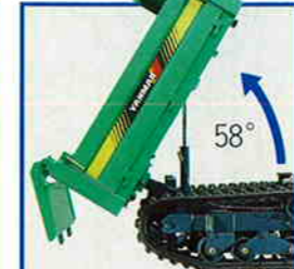
ゆよりのダンプ角とダンプクリアランス
