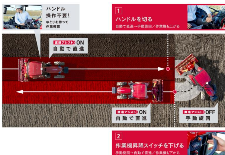
<直進アシスト機能を使った作業イメージ>
