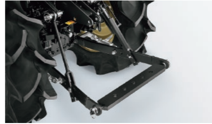
リンケージドローバ ロアリンクに装着できるドローバヒッチです。
