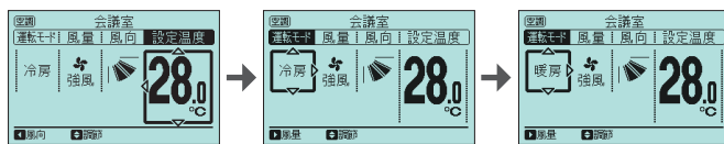
① 現在の運転状態 ② 左右ボタン(◀▶)で項目を選択 ③ 上下ボタン(↑↓)で設定を変更
