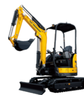
4柱キャノピー仕様 (ROPS※1/FOPS※2基準)
