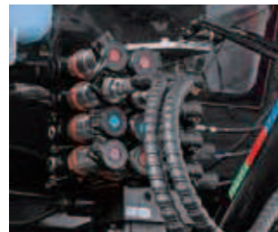
■ サブコン4連目KIT 油圧取り出し4連目を追加できるKIT。 ※3連目は油圧トップリンクで使用。
