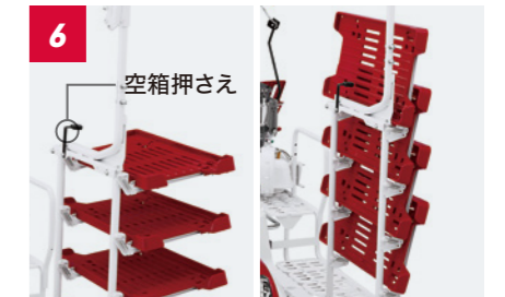
6 折りたたみ式予備苗のせ台 格納時など必要に応じて上方に折りたためます。
