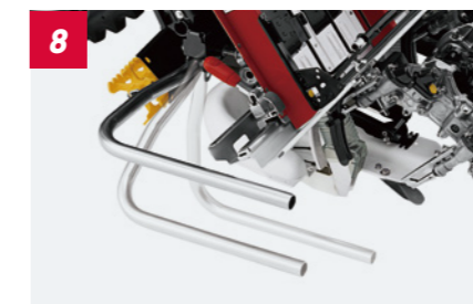
8 スタンド兼用ガード 作業時は機械を守り、折りたたむとスタンドに。
