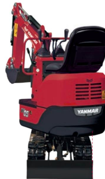
旋回時の上部体はみ出し幅 最大 **240mm**
