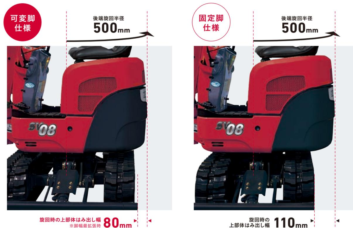
最小クラスの後端旋回半径 超コンパクト設計なので狭所作業を安心して行えます。
