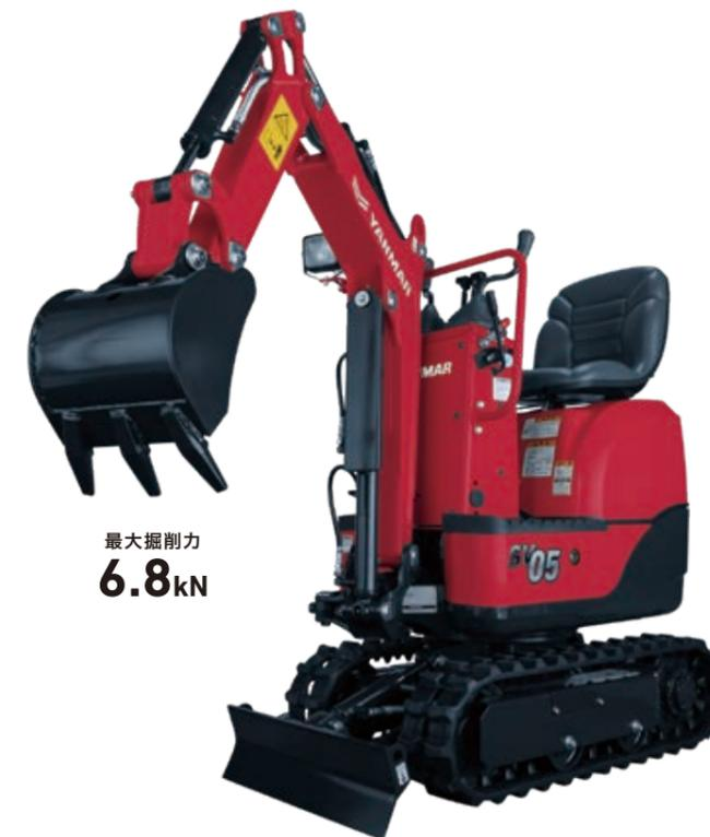
最大掘削力 **6.8kN**
