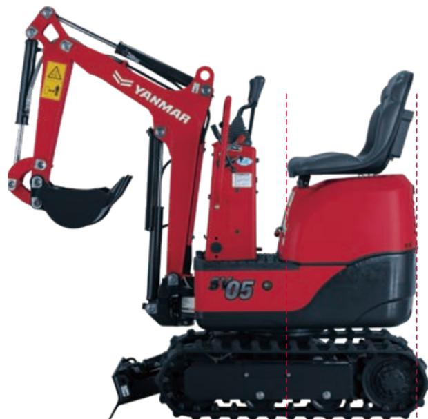
後端旋回半径 **530mm**
