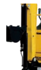
ブームシリンダーガード 抱え込み作業もガードでシリンダーが傷つくのを防ぎます。
