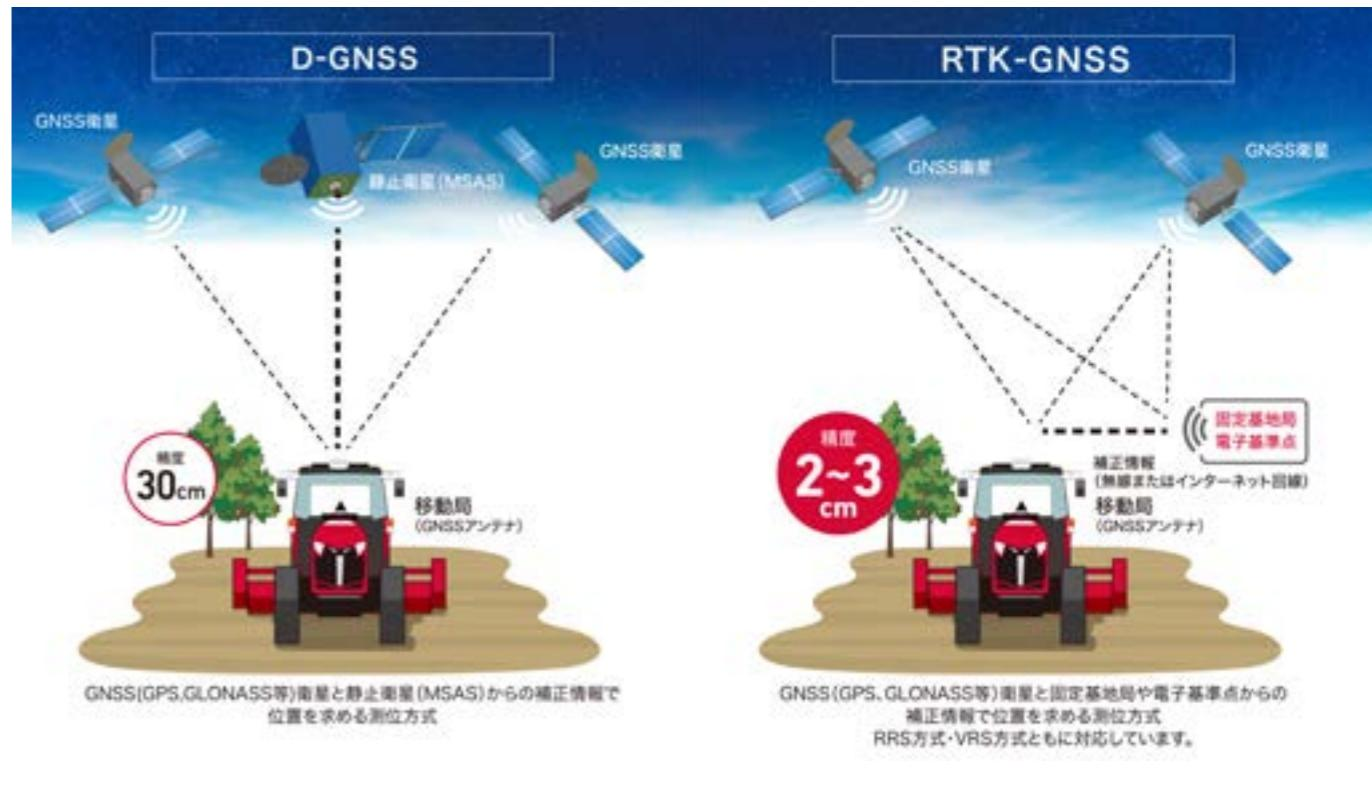
直進アシストはD-GNSS方式で位置情報を取得しています。オプションとして、さらに高精度な位置情報を取得できるRTK-GNSS方式もご用意しています。
