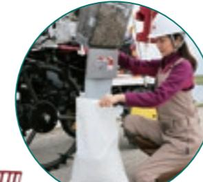
ホッパが左右に開き、両サイドの排出口から残った肥料を排出できます。また、苗皿も簡単に着脱できるため、メンテナンスもラクラクです。
