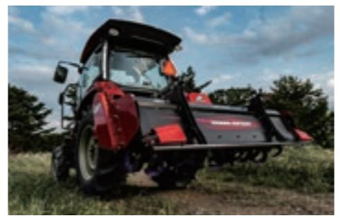
●野菜残渣のすき込み、転作田での収穫残渣のすき込み、稻わらや麦稈のすき込み、緑肥のすき込みなど、すき込み力のアップを図ったロータリーです。有機物のほ場への還元も可能となりました。
