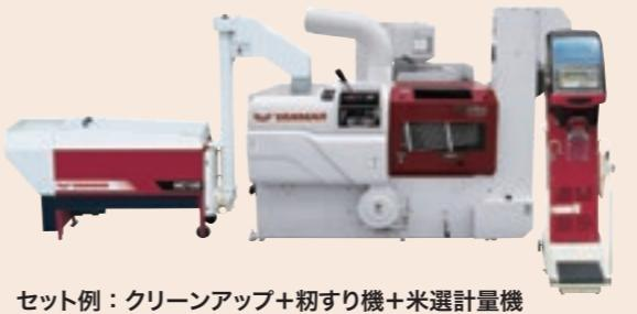
セット例：クリーンアップ+糀すり機+米選計量機
