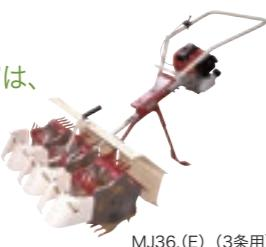
●ローターの回転により、悪性のガスを抜き、酸素を供給することで、苗の分けつけを促進して有効茎数を早期確保します。また地温が高まり、開張型の稻が育ちます。
