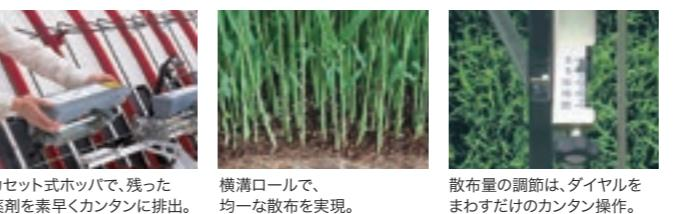
カセット式ホッパーで、残った薬剤を素早くカンタンに排出。 横溝ロールで、均一な散布を実現。 散布量の調節は、ダイヤルをまわすだけのカンタン操作。
