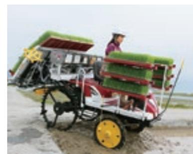
ペダルをいっぱいに踏み込んだときの最高速度を3段階で設定できる速度設定機能を使えば、低速で作業したいときなど、ペダルの踏み込み調節が不要になります。
