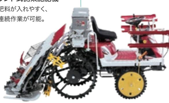
田植えと施肥が同時にできるため、手間も人手も省けます。また、苗のすぐ横の土中に条施肥するため、少ない施肥量でOK。ほ場外への肥料の流出も少なくてすむため、水質汚染防止に役立ち、湖沼の富栄養化を防ぎます。
