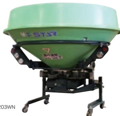
●面積当たりの肥料散布量と、あらかじめ計測しておいた肥料流動測定値をナビゲーターに入力すると、トラクター天井上部に取付けたGPSアンテナから自動的に得られた速度情報に基づいて、シャッター開度を自動調整して高精度な散布を行います。
