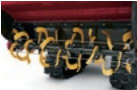
すき込み性・細土性に優れた新反転爪を採用。回転径490mmの大きな爪で、反転性とすき込み性能がアップしました。
