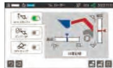
タッチパネル式モニターに各機能の設定やアーム高さ、ダンプ角度を表示。作業状態を一目で確認できます。
