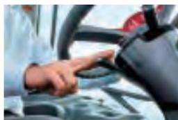
作業機昇降スイッチで作業機を上げるとPTOが切れ、下げるとPTOが入る。旋回時の操作が少なくなつて作業がラクに。
