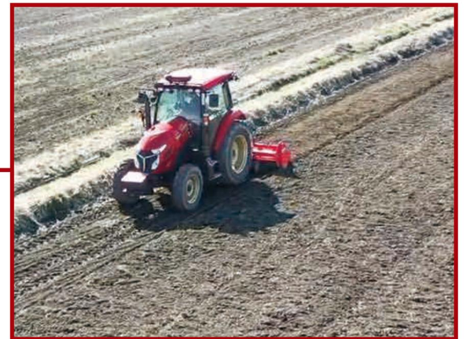
事前に設定した経路において・ステアリング操作、作業機昇降、前進・後進切替え、停止、PTO入・切、車速調整などを自動で行う。
