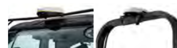
■ アンテナユニット キャビンフレームまたは安全フレームの上方にレイアウト。
