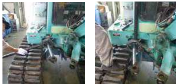
シリンダーヘッド取外し工具を使用した作業風景
