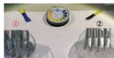
①: 強アルカリ洗浄剤 (pH12) ②: 他社製アルミフィンクリーナー (pH12以上)
