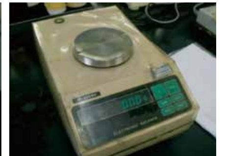
最大1/1000g計測できる微細な計量器を用いる
