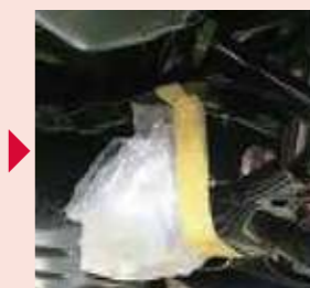
シフト塩カル防錆剤 上塗り
