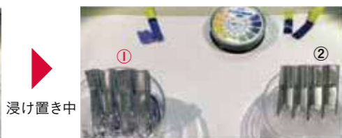
①: 強アルカリ洗浄剤 (pH12) ②: 他社製アルミフィンクリーナー (pH12以上)
