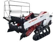
歩行型たまねぎピッカー HP101T,(W) (ミニコンテナ取付仕様) HP101T,(W)LC (鉄コンテナ取付仕様)
