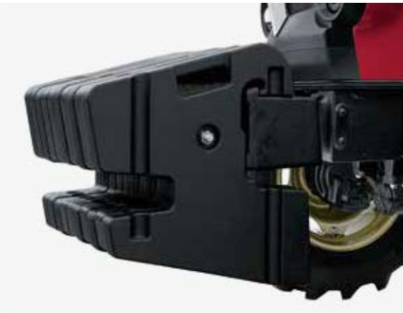
■ 신 프론트웨이트 45kg 웨이트 전면이 위로 올라가게 설계하여, 논두렁 가까이까지 작업이 가능. ※ 후륜 웨이트 키트 200kg 추가 가능
