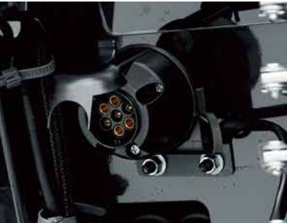
■ DIN 커플러 KIT DIN 규격의 외부 전원 추출에 대응합니다.
