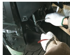
クラッチペダルの遊び調節
