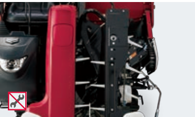
引起しケースカバー着脱
