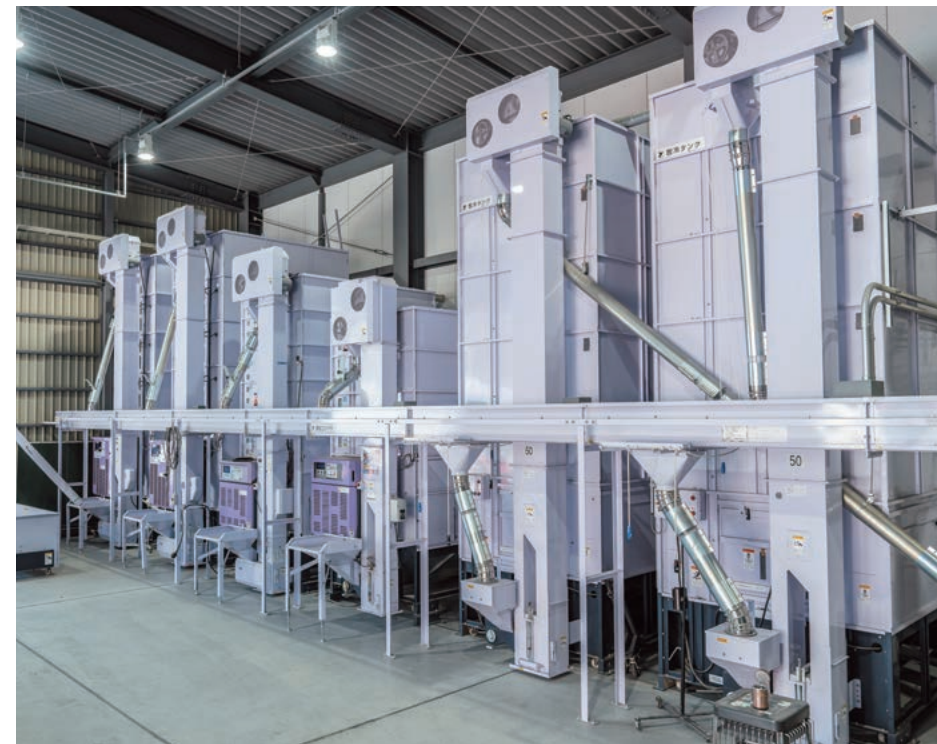
乾燥機から放冷タンクまでの自動搬送や、1人で2台の籾すり機を操作できる機械配置、玄米ブールからフレコン計量器までの動線など、ライスセンターはスムーズなライン設計がされている。
