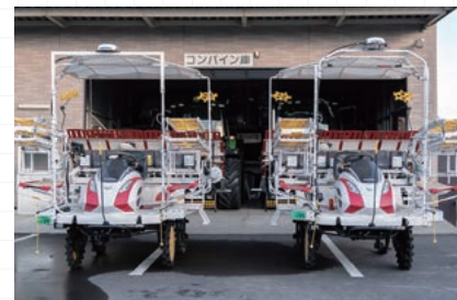
自動操舵システムを追加搭載したYR8Dが、 高度な植付け精度を実現。
