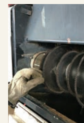
厚手の革手袋を着用し、カッター刃の摩耗を確認。
