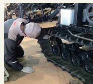
クローラの亀裂およびスプロケットの摩耗具合を確認。
